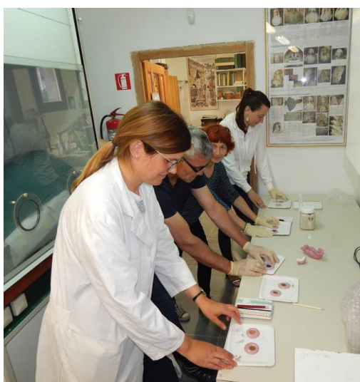
Slika 22 Udeleženci delavnice izdelujejo silikonski kalup za izdelavo replike kovanca (foto: Lidija Gardina)
