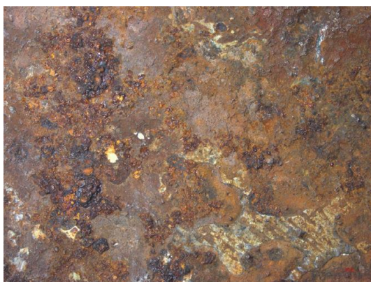
Slika 15 Mikroskopska fotografija korozijskih produktov na železu (foto: Nataša Nemeček, Zala Uršič)
