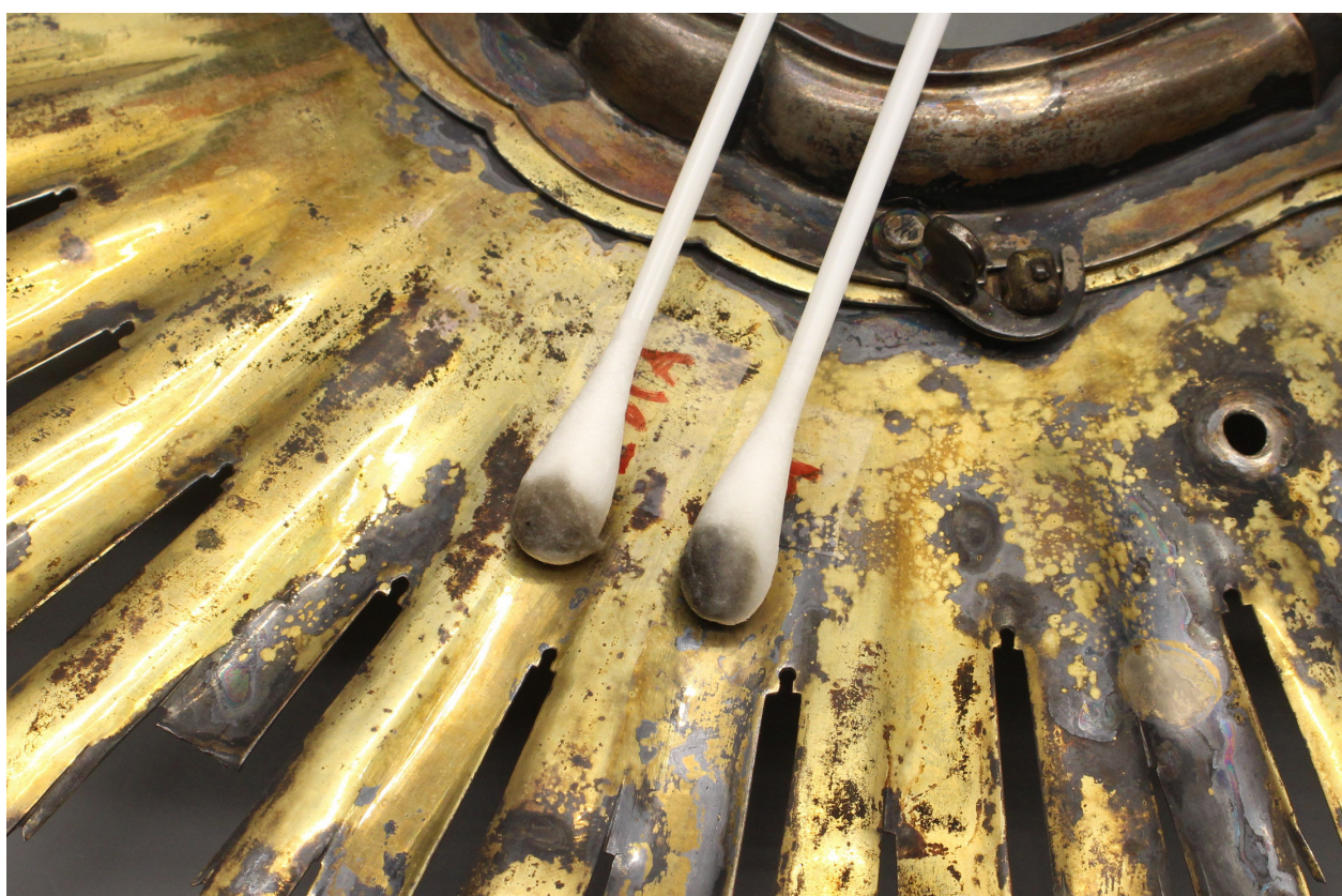
Slika: Odstranjevanje korozijskih produktov bakra in srebra na pozlačenih žarkih baročne monštrance iz 18. stoletja Hrani: Muzej krščanstva na Slovenskem, Stična (foto: Nataša Nemeček)
